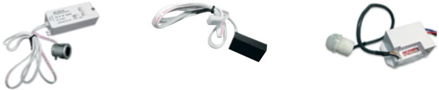
**Sensore IR:** rileva movimento fino a 6 cm dal sensore. Con movimento breve funzione di accesso o spento, se si tiene la mano nella zona del sensore si attiva il dimmer. Disponibile versione on/off per ante armadi e cucine. Sensore diam 20 mm e h 19,5 mm.
