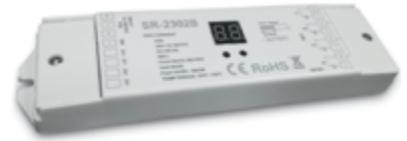
**Dimmer DALI:** sistema di controllo luci mediante Software o DALI Master (non incluso) collegato con bus a un Dali Dimmer.
